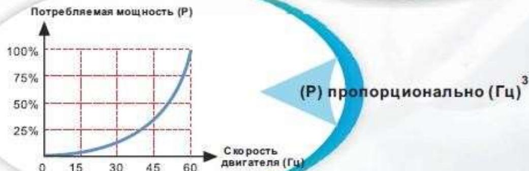
Управление скоростью двигателя в соответствии с необходимой производительностью обеспечивает экономию электроэнергии.
